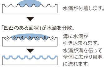
試験方法 ①タイル表面を水湿後、水を一定量滴下した直後のタイル表面状態(水たまり具合)を比較。
